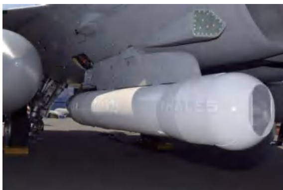
/ “塔利奥斯” 瞄准激光指示吊舱。
