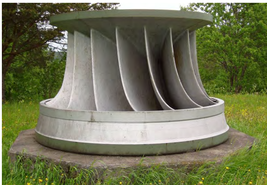
Figur 4.3. Roterende del av en francisturbin. De har vanligvis mellom 10 og 20 turbinblader, som vist på bildet. En kaplanturbin har en utforming som likner mer på en båtpropell, og har vanligvis mellom 4 og 8 blader. Foto: Eva B. Thorstad.
